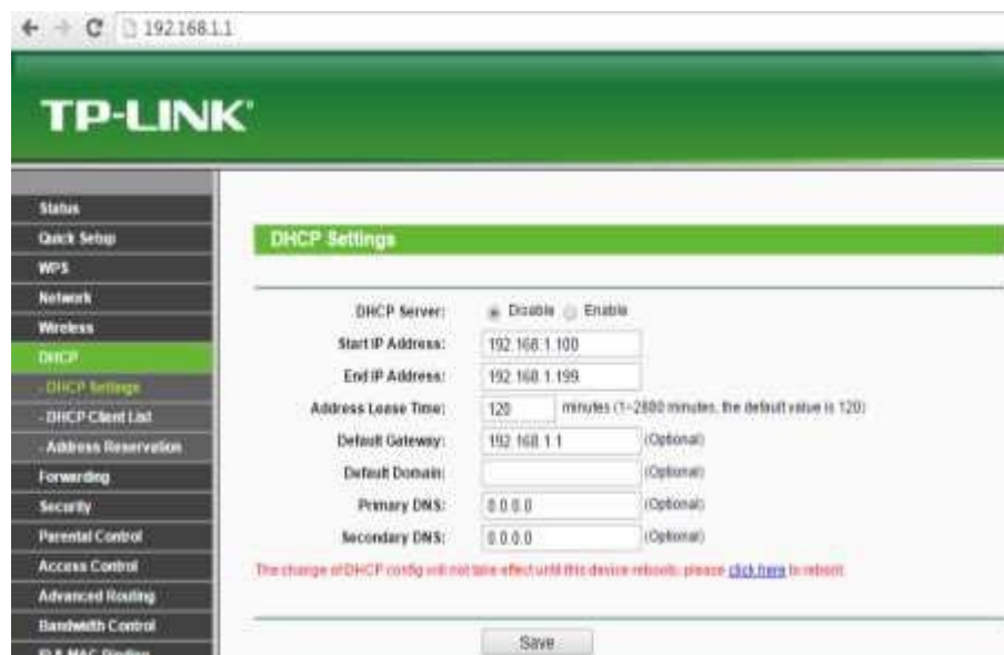
Gambar 21 Menonaktifkan DHCP Pada Router Server
