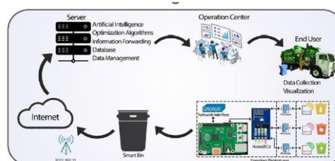
Gambar 1. Arsitektur system tempat sampah otomatis Sumber gambar : springer,2024 hal.56
