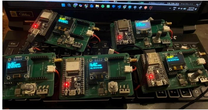
Gambar 7. Perangkat ESP32 untuk pengujian integrasi IoT
